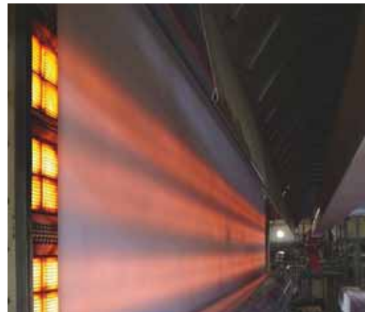
Perfekte Trockenleistung durch kontaktlose Infrarot-Trocknung.
